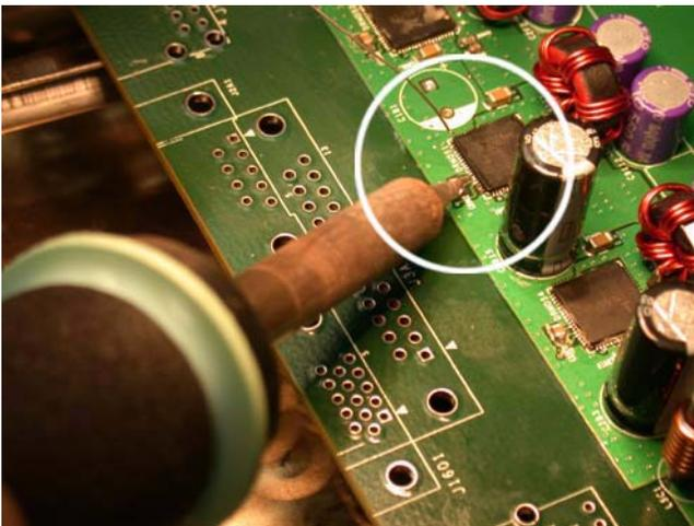
FIGURE 19. INDIVIDUAL SOLDER JOINT REWORK
