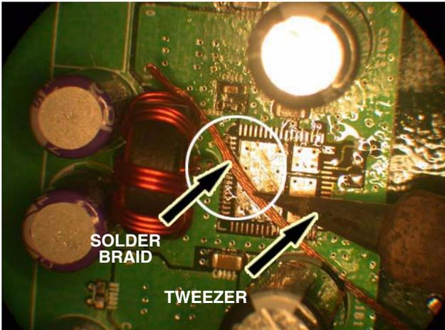
FIGURE 12. SITE REDRESS USING SOLDER BRAID
