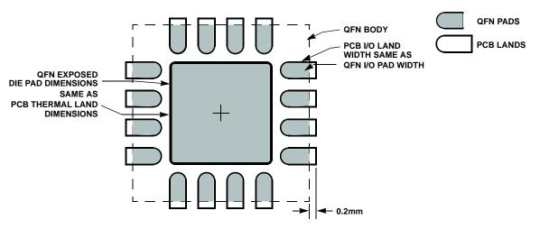
FIGURE 2. TYPICAL QFN LAND PATTERN LAYOUT WITH PACKAGE OVERLAY
