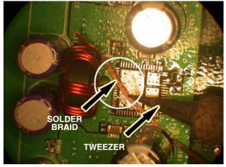
FIGURE 12. SITE REDRESS USING SOLDER BRAID
