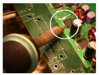
FIGURE 19. INDIVIDUAL SOLDER JOINT REWORK "ONE BY ONE"
